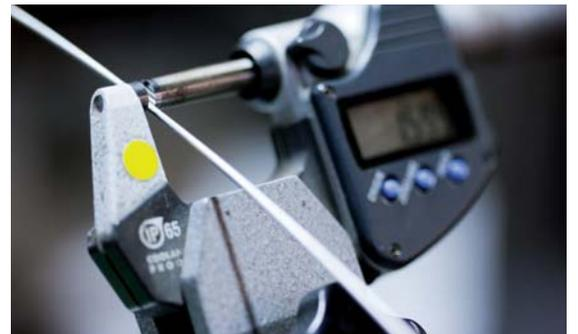
Produktionsbegleitende Qualitätskontrollen im eigenen Prüflabor. Mit computergestützten Materialprüfungen werden in jeder Prozessphase Torsion, Zug-, Druck- und Biegefestigkeit geprüft.
